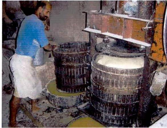
Figura 3.3 – Atividade de prensagem no processamento da mandioca.
