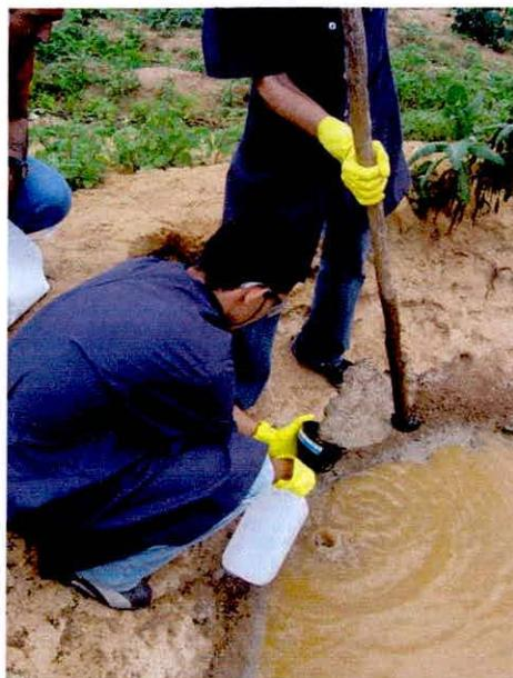
Figura 4.5 - Coleta do lodo para inoculação do sistema.
