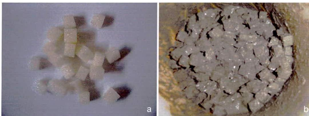
Figura 4.6 - Espuma de poliuretano. (a) isenta; (b) impregnada com inóculo.
