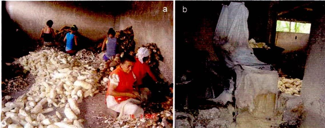
Figura 3.2 - Atividades para processamento da mandioca. (a) descascamento, (b) trituração.
