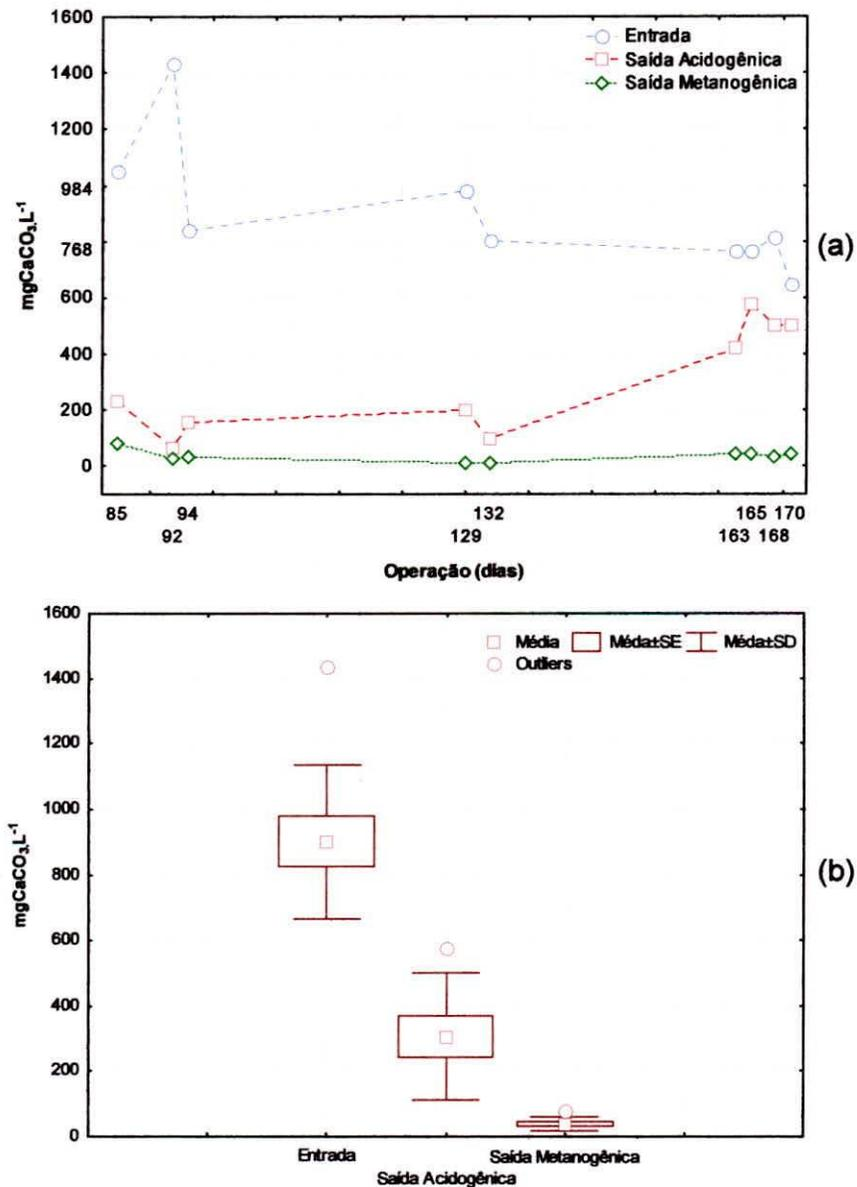
Figura 5.12 – AV (mgCaCO<sub>3</sub>.L<sup>-1</sup>) para E10: (a) variação temporal; (b) *box plot*.
