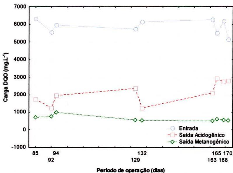
Figura 5.15 - Variação de DQO (mg.L<sup>-1</sup>) no sistema para E10.
