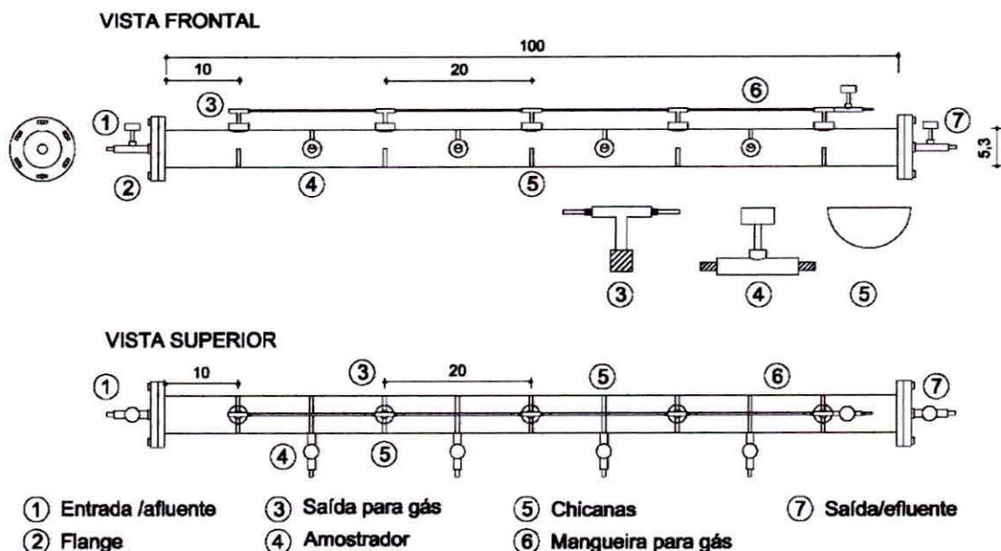
Figura 3.16 - Reator Anaeróbio com Chicanas. Adaptado: Barboza (2005).
