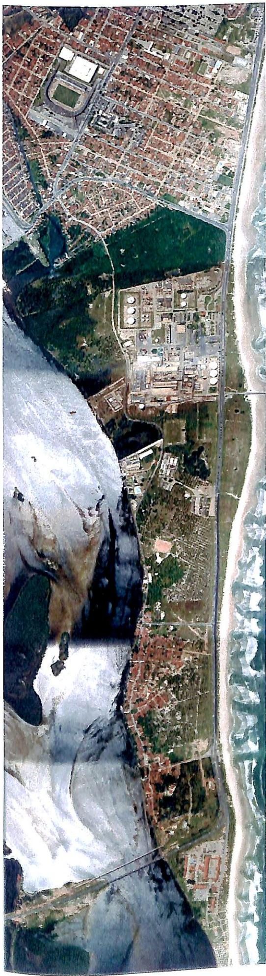
Figura 1.b – Mosaico não controlado de fotografias aéreas, na escala aproximada de 1:19.300; apoio suplementar à Figura 1.a.. (Foto: D.F.L.J. / equip. Hasselblad 553 ELX, 80 mm, filme 160 ASA. Avião de propriedade de Manal Ltda.. Data do vôo: nov. 1999).
