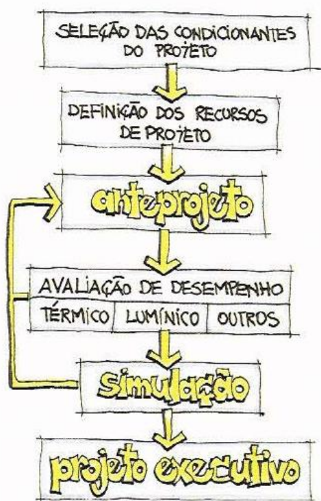
Figura 21 - Maneira lógica de projetar. Fonte: LAMBERTS ET AL, 1997.
