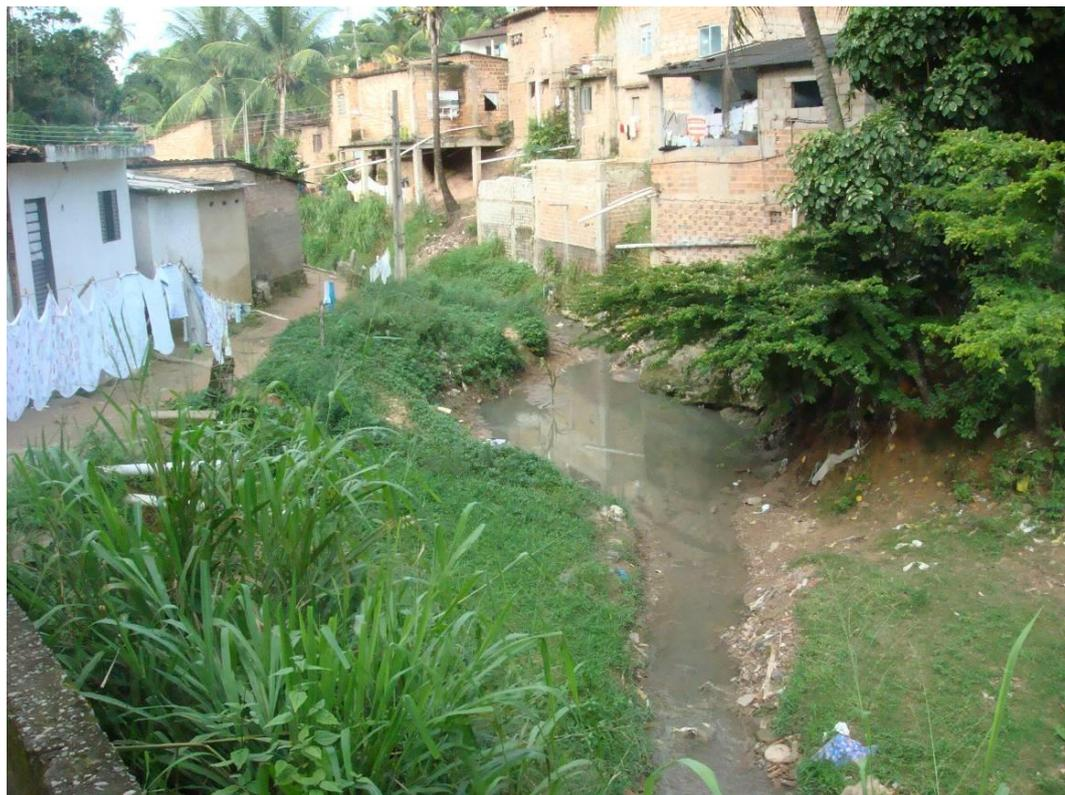
**Ilustração 6: Esgotamento sanitário residencial canalizado no riacho dos Ossos com resquícios de lixo provocando assoreamento das margens
