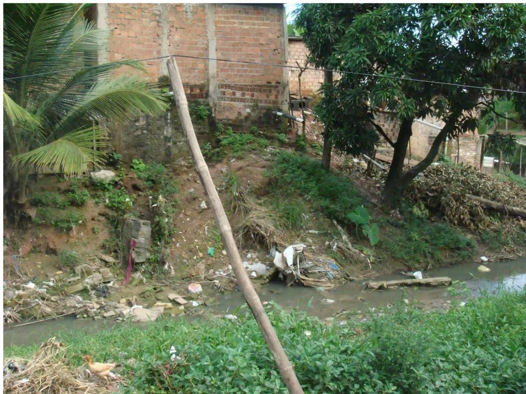
**Ilustração 12: Construções irregulares nas margens do rio Reginaldo, ameaçadas por desmoronamento devido as enchentes que provocam deslizamento de barreiras
