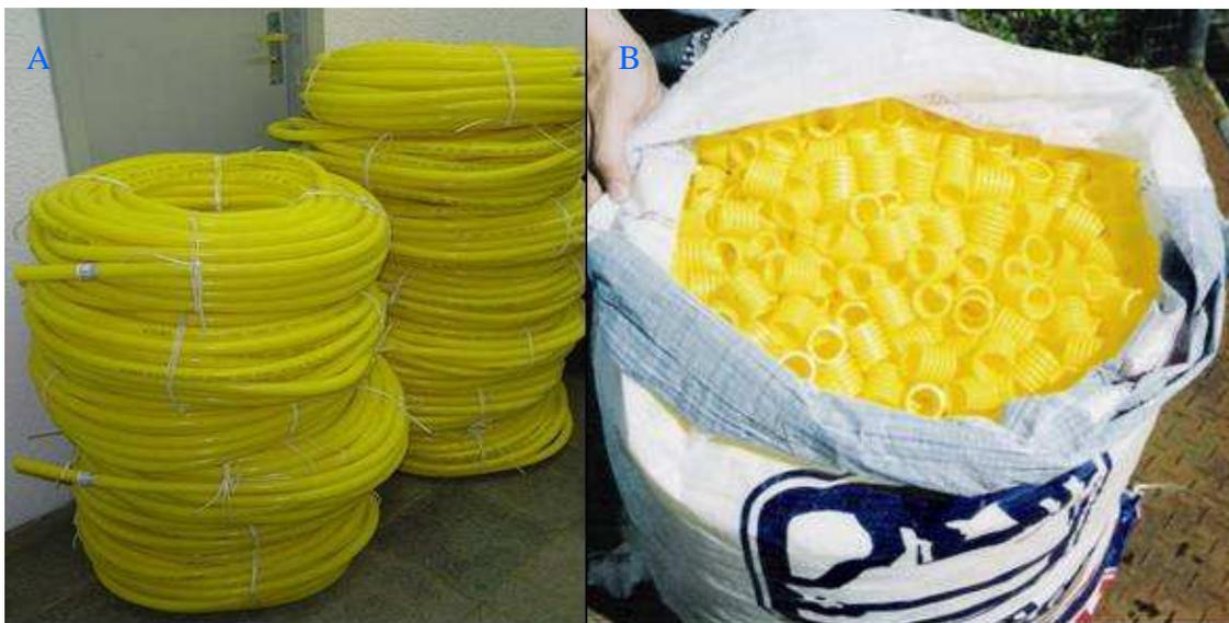
**Figura 4.7** – Conduítes inteiros (A), anéis cortados (B).
