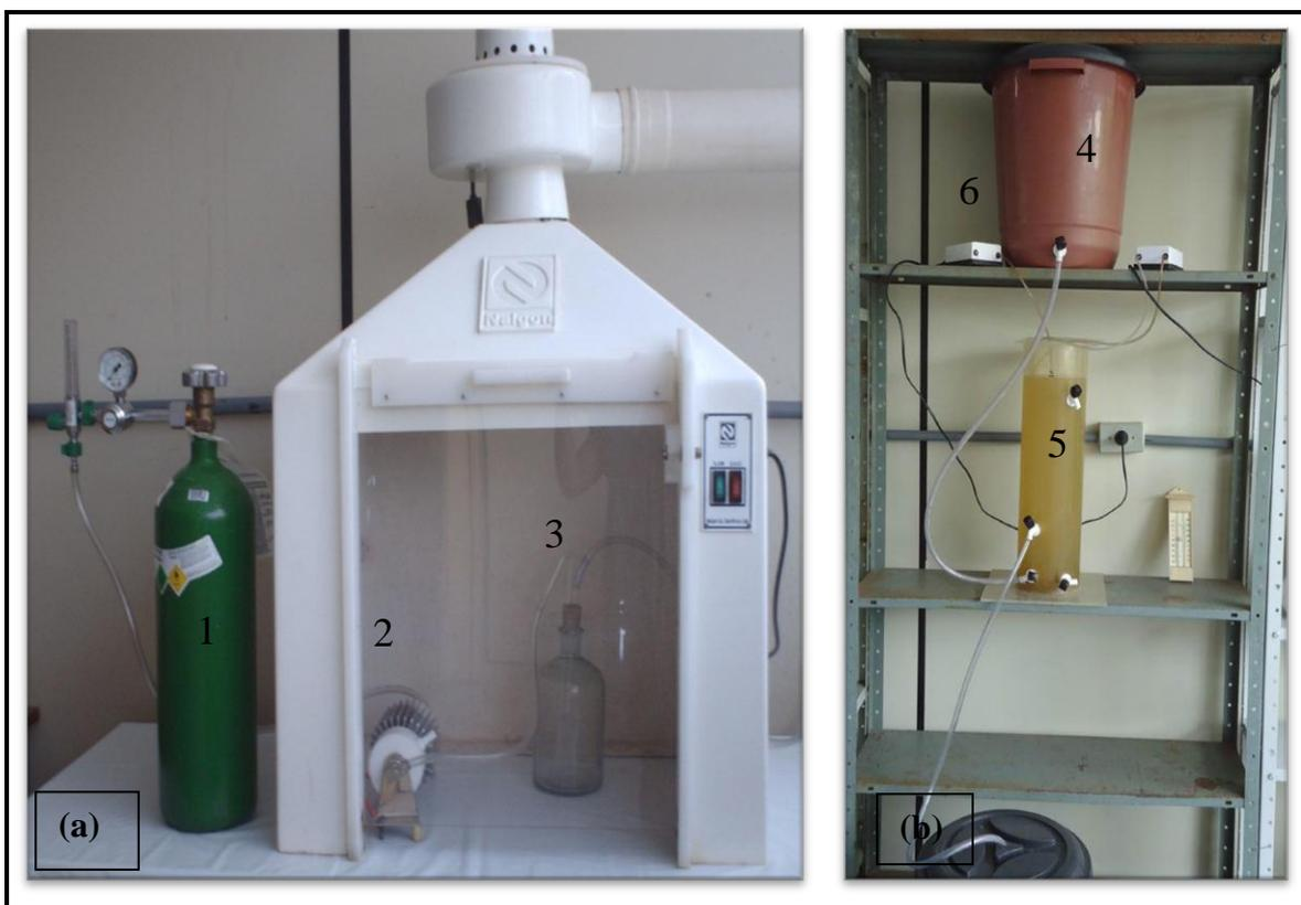
Legenda: (1) cilindro de oxigênio, (2) ozonizador, (3) tanque de contato, (4) tanque de armazenamento, (5) AeSBR, (6) aerador.
