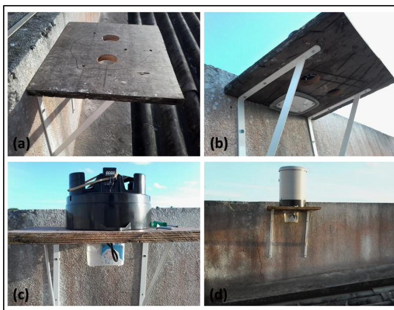
Figura 17 – Suporte do pluviômetro (a) e (b), proteção do datalogger (c) e (d).
