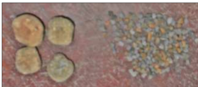
Figura 3 – À esquerda, argila expandida antes de ser triturada; à direita, argila expandida após o processo de redução granulométrica.
