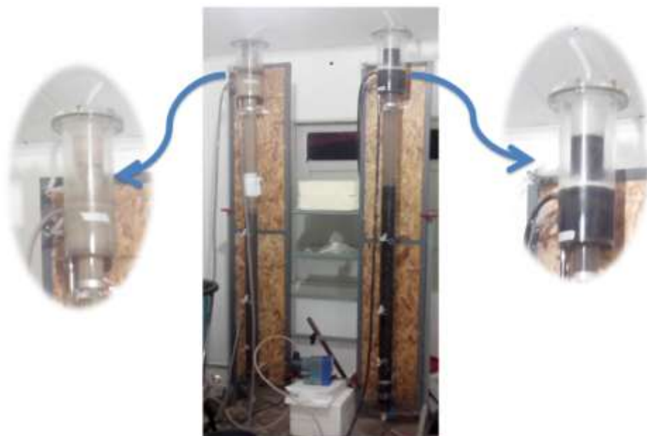
Figura 6 – Fotografia do RALF 1 e do RALF 2 em operação, com destaque para os separadores gás-líquido de ambos os reatores.
