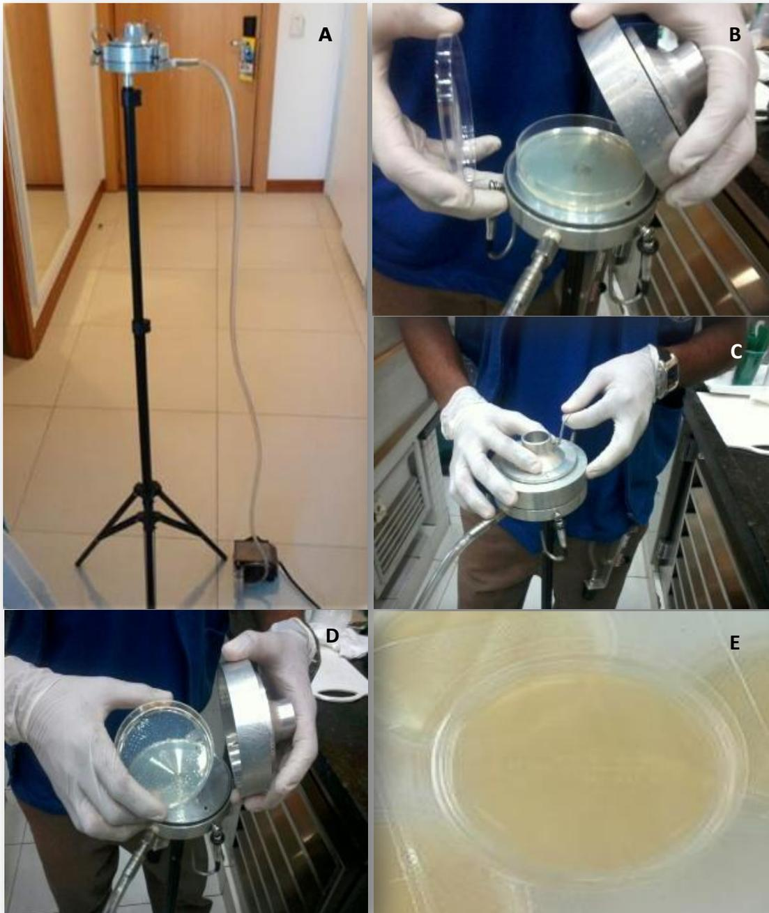
**Figura 3** - Amostrador de ar do tipo Anderson® de um estágio
